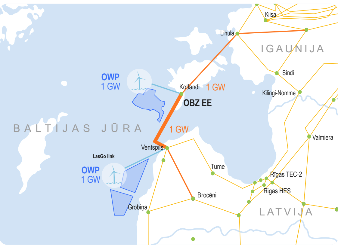
12. attēls. Ceturtnā Latvijas–Igaunijas starpsavienojuma projekts Ceturtnā Latvijas–Igaunijas starpsavienojuma drošam un stabilam darbam ir nepieciešams izbūvēt iekšējā 330 kV tīkla pastiprinājuma projektu Ventspils–Brocēni un tālāk no Brocēniem starpsavienojumu uz Lietuvu līdz apakš-
